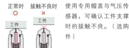
使用专用帽盖与气压传感器，可确认工件支撑时的接触不良。（选购件）
